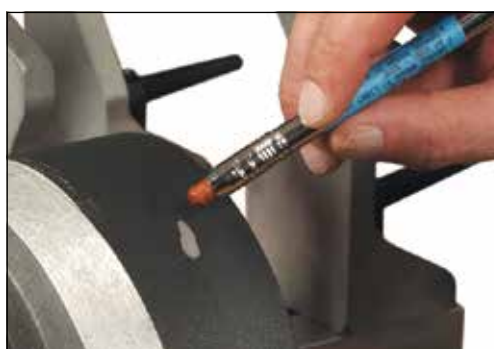
Temperaturkontroll med mätpenna
