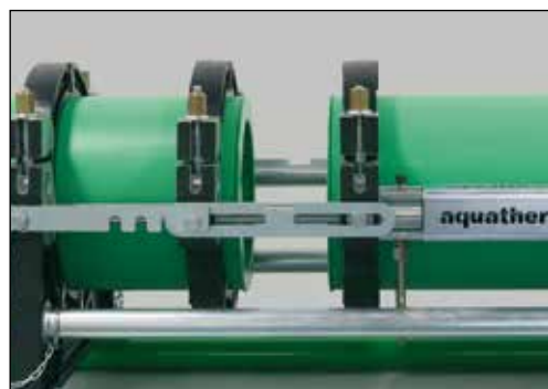
Dela på maskinsliderna och för bort svetsvärdet
