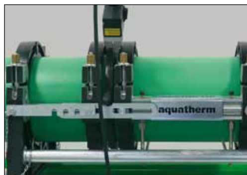
Rören trycks mot svetsvärdet
