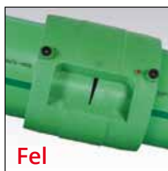
För att uppnå ett stabilt svetsresultat skall de båda rörändarna vara plana och parallella
