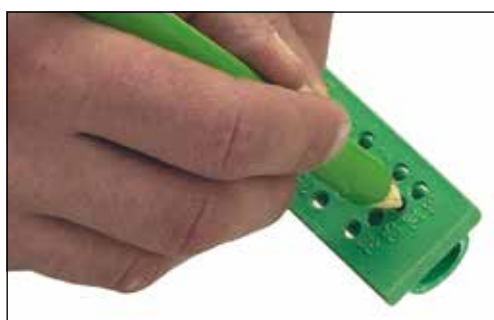
Markering av insvetsningsdjupet
