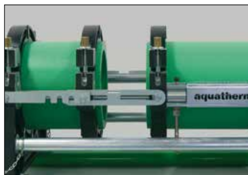
Delarna som skall svetsas fixeras och centreras
