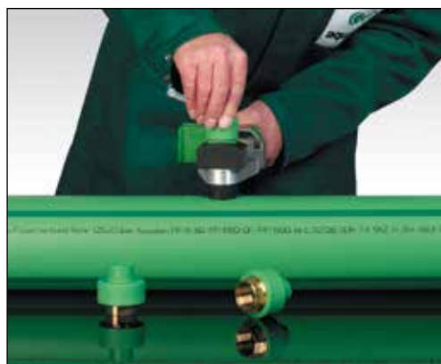
Uppvärmning av det element som skall svetsas
