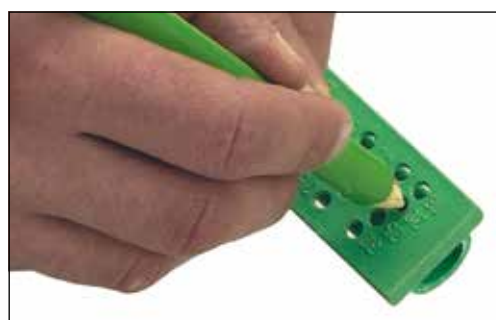
Markering av insvetsningsdjupet
