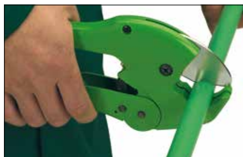
Avklippning av röret
