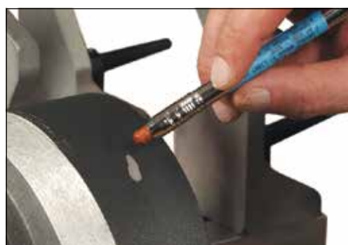
Temperaturkontroll med mätpenna
