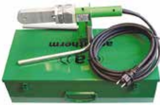
Art nr 50136 Handsvetsspegel (mini), för 1 dorn (500W) för PP muffsvetsning för hand. Passar svetsdorn dim 16 - 32 mm. Plats för 1 st svetsdorn. Kommentar: Liten smidig svets då man har platsbrist och behöver komma åt på lite "besvärligare ställen".
