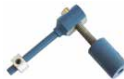
Art nr 50307-50311 Reparationsset Kommentar: Man kan laga hål i PP rör med reparationsplugg. Borra upp skadan med 7 eller 11 mm borrar och plugga.
