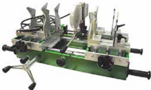
Art nr 50147 Rörsvetsmaskin XL (1400W) för PP muffsvetsning. Passar svetsdorn dim 50 - 125 mm. Handsvets (art nr 50141), Rörstöd samt svetsdorn dim 50 - 125 mm ingår. Kommentar: Standardsvets-maskin för bänkarbete i dim 50 - 125 mm.
