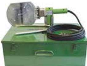
Handsvetsspegel för 1 dorn (1400 W) för PP muffsvetsning för hand. Passar svetsdorn dim 50 - 125 mm. Plats för 1 st svetsdorn. Kommentar: Svetsen används för större dimensioner då man behöver svetsa för hand på plats.
