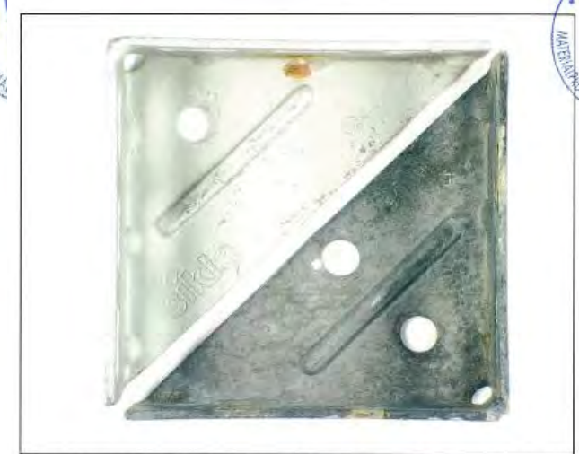
Abb. 32: Winkelkonsolen 100/100 nach 10 Zyklen KWF; oben EOT 400, unten stückverzinkt
