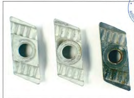
Abb. 27: Gewindeplatte HZ 41-M 10 nach 10 Zyklen KWF; links 2x EOT 40, rechts stückverzinkt
