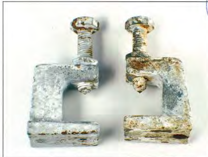
Abb. 1: Trägerklammer TCS M10/M10 nach 1440 h SS-Test; links EOT 40 rechts stückverzinkt
