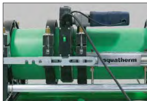
Rørendene høvles plane.
