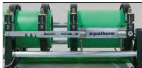
Separer maskinsleidene og fjern varmesverdet.
