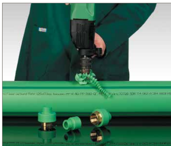
Gjennom boring av rørveggen
