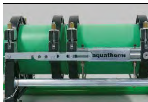
Trekk sammen rørene. Avkjøles under trykk.
