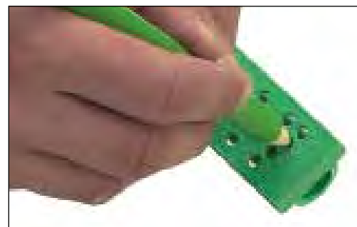
Markering av fusjonsdybde
