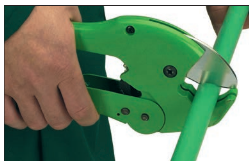
Avklippning av röret
