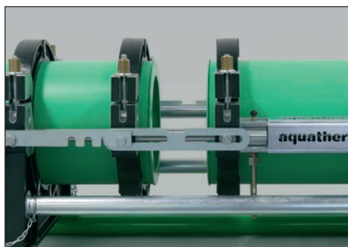
Dela på maskinsliderna och för bort svetsvärdet
