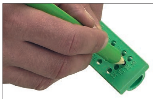
Markering av insvetsningsdjupet
