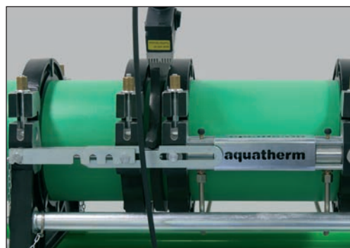
Rören trycks mot svetsvärdet
