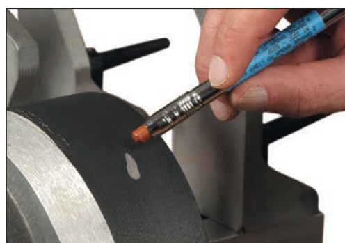
Temperaturkontroll med mätpenna
